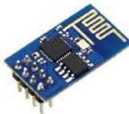
**Gambar 4** Modul ESP8266
